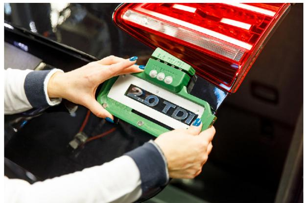
*Não é necessária qualquer ferramenta ou usinagem para construir um modelo. O custo é muito inferior aos métodos tradicionais de fabricação e os resultados podem ser adaptados de modo a corresponderem aos requisitos exatos.*
